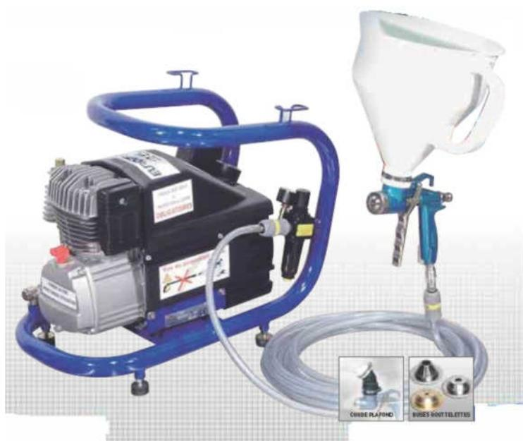
Le pistolet traditionnel est utilisé pour l'application de peinture ou de produits liquides grâce à de l'air fourni par un compresseur et permettant la pulvérisation du produit en sortie de buse.
